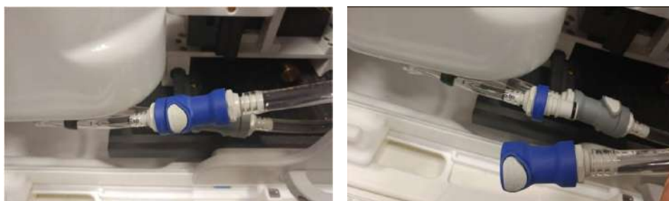
Bild B - 1: Frånkoppling av vattenarmatur
