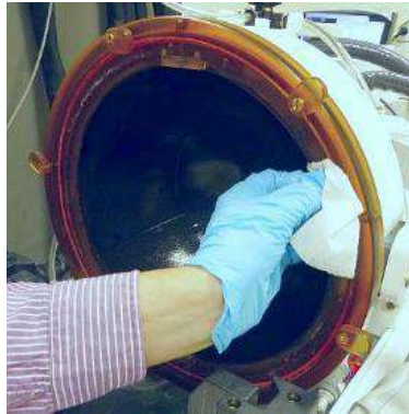
Figura 12-1: Procedimiento de manipulación del transductor
