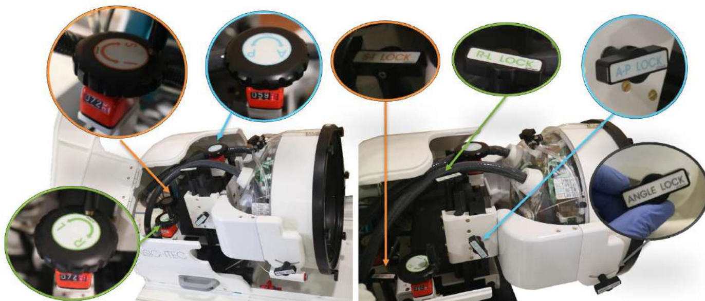
Figura 3-10: Unidad de posicionamiento mecánico. Palancas (izquierda), bloqueos (derecha).
