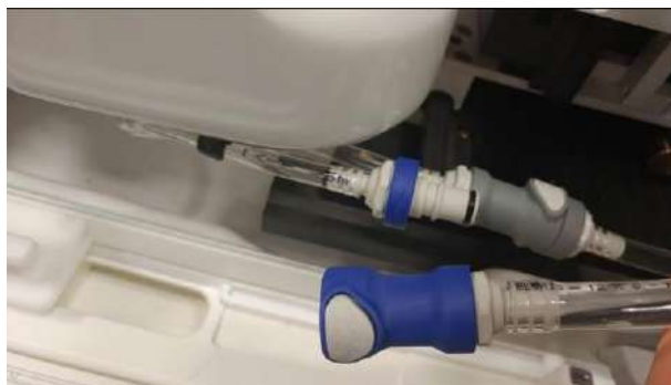
Figura B-1: Desconexión del accesorio de agua
