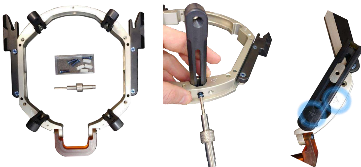
Figura A-3: Conexión de los postes del marco (solo con fines ilustrativos)
