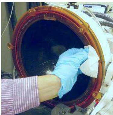
Figura 12-1: Procedimiento de limpieza del transductor
