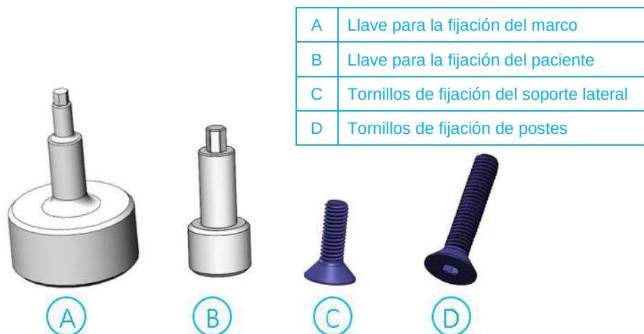
Figura 1-16: Tornillos y llaves del marco estereotáctico craneal
