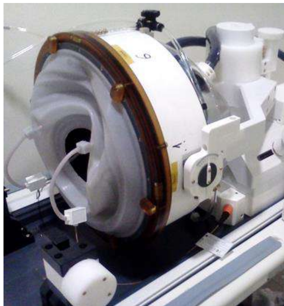
Figura 3-12: Conector y toma de la bobina cefálica TcMRgFUS de 1,5 T (solo para fines de ilustración)
