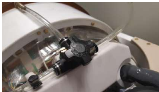
Figura B-2: (I) Bolsa de agua y tubo de silicona con accesorios, (D) Apertura de la válvula de escape de aire
