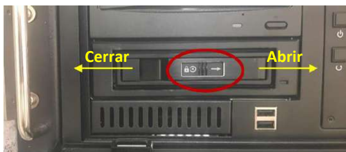
Figura C-2: Compartimento del disco duro de los PC (observe la ranura con las designaciones de las posiciones Open/Lock [Abrir/Cerrar])
