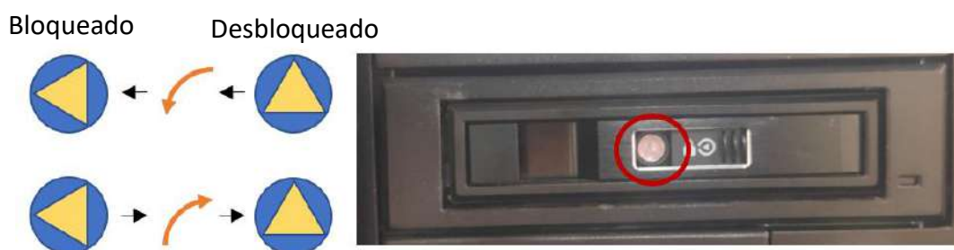
Figura C-3: Posiciones de cerradura y de bloqueo/desbloqueo
