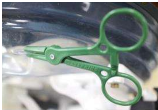
Figura 3-25: Ejemplo de uso de la pinza de mitigación de fugas
