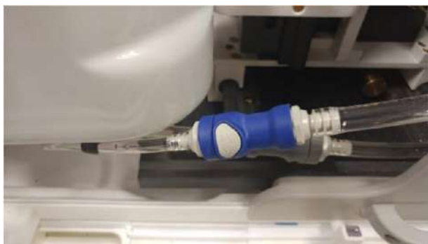
Figura B-1: Desconexión del accesorio de agua
