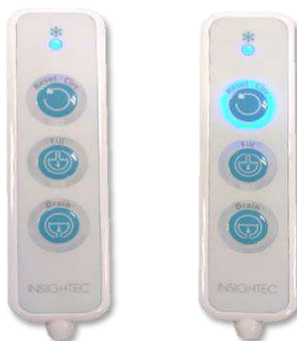
Figura 3-19: Estados del control remoto del circuito de agua: Inactivo (izquierda) y mientras la circulación está activada (derecha)
