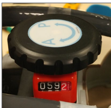
Obrázok 3-11: A-P polohovacia páka
