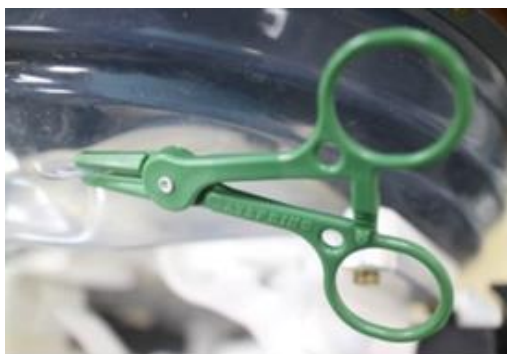
Bild 3-26: Exempel på användning av klämman för läckagebegränsning
