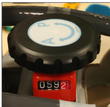
Figura 3-11: Manetă de poziționare A-P
