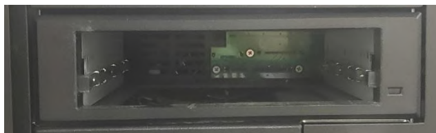
Figura C-5: Compartimentul pentru hard disk al PC-urilor când discul este scos
