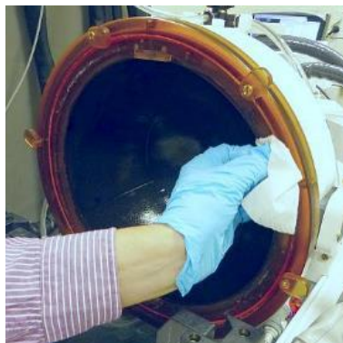
Figura 12-1: Procedura de curățare a transductorului
