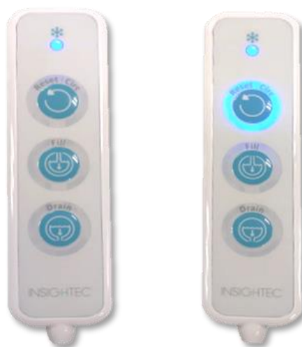
Figura 3-19: Stările telecomenzii pentru sistemul de apă: Inactiv (stânga) și în timp ce circulația este activă (dreapta)
