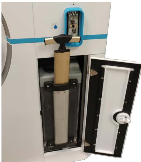
Figura 12-2: Procedura de dezinfectare a transductorului și a sistemului de apă
