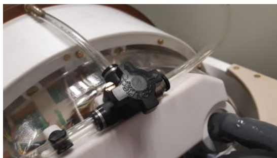
Figura B - 2: (L) Pungă de apă și tub din silicon cu fittinguri, (D) Deschiderea supapei de eliberare a aerului
