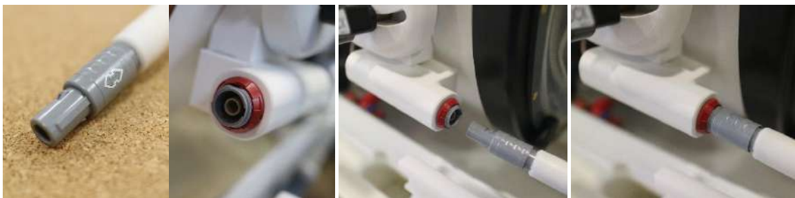
Figura 1-22: Ficha do conector da antena ligada à tomada de ligação (apenas para efeitos ilustrativos).
