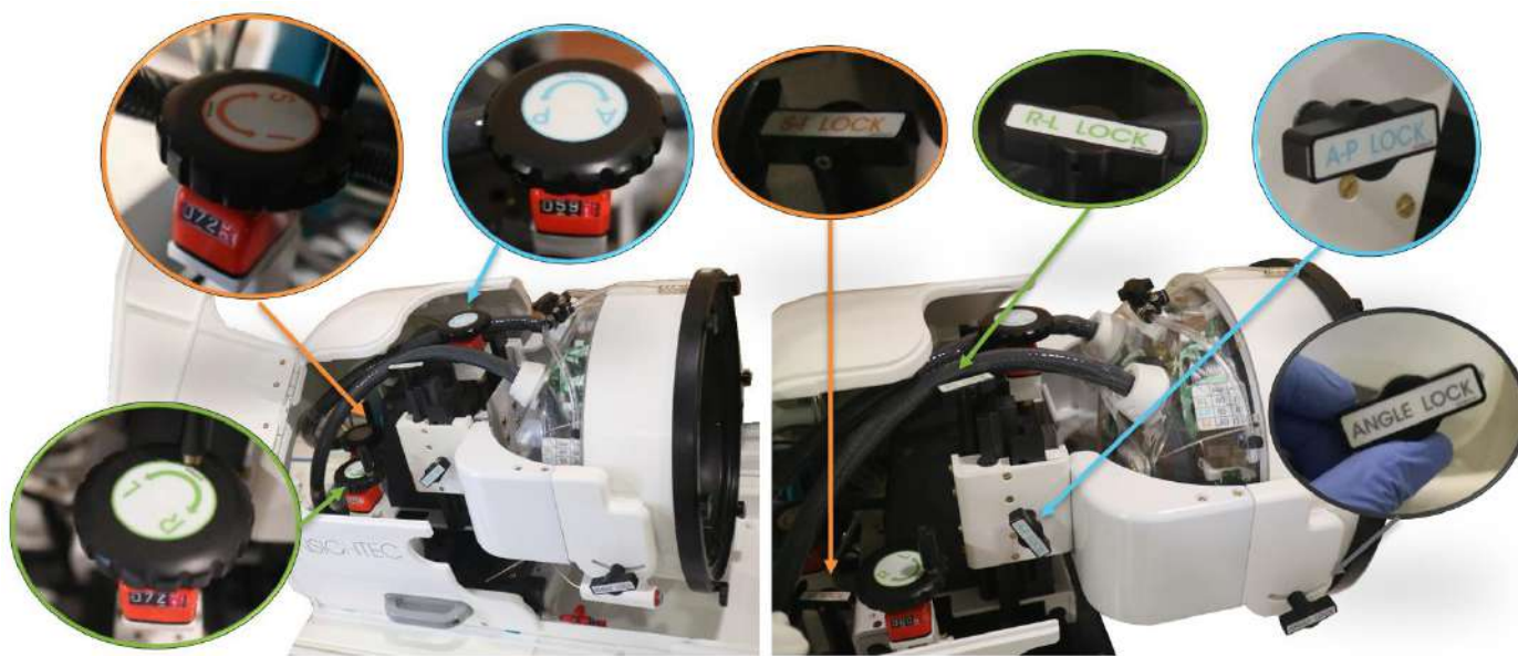
Figura 3-10: Unidade mecânica de posicionamento. Alavancas (esquerda), fechaduras (direita).
