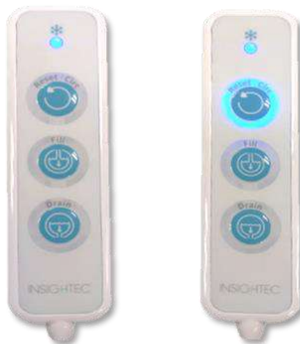
Figura 3-19: Estados do controlador remoto do sistema de água: Parada (Esquerda) e Enquanto a circulação está ativa (Direita)
