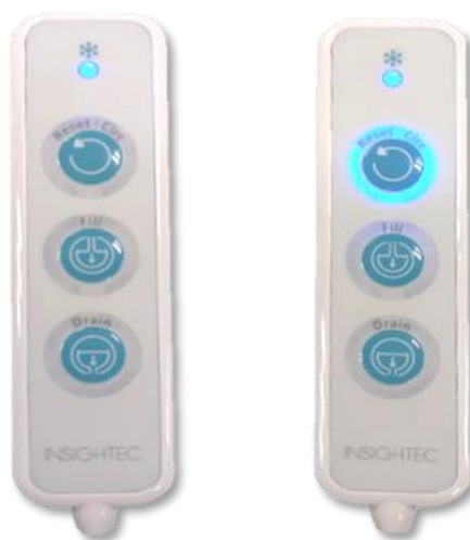
Figur 3-20: Statuser på fjernkontrollen for vannsystemet: Inaktiv (venstre) og mens sirkulasjonen er aktiv (høyre)
