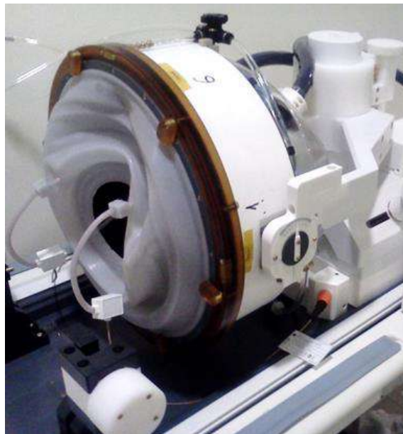
Figura 3-13. Spina e presa del connettore della bobina per testa TcMRgFUS da 1,5 T (solo a scopo illustrativo)
