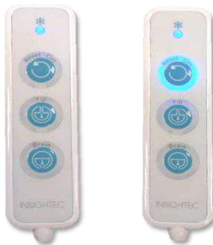
Figura 3-20. Stati del telecomando del sistema idraulico: Inattivo (sinistra) e con circolazione attiva (destra)
