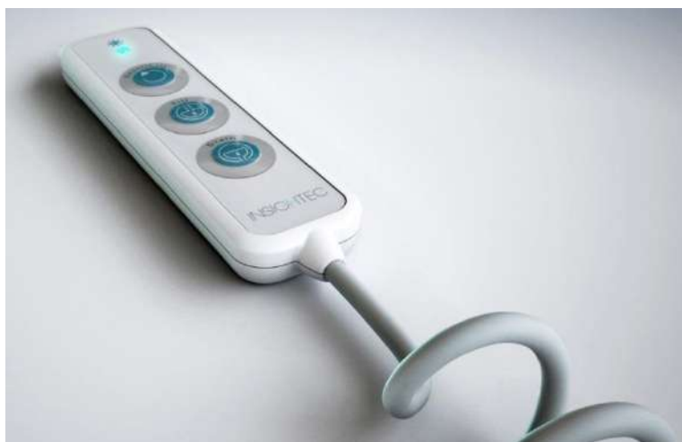
Figura 3-19. Telecomando del sistema idraulico
