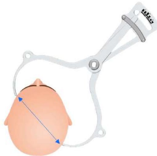
Figura 1-13. Calibro Exablate per la misurazione della diagonale della testa e la stima delle combinazioni
