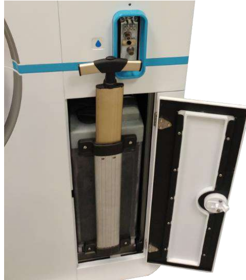
Figura 12-2. Procedura di disinfezione del trasduttore e del sistema idraulico
