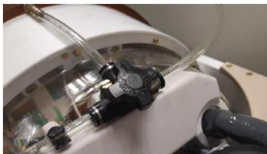
Figura A-2. (sx) Sacca dell'acqua e tubo in silicone con raccordi, (dx) apertura della valvola di rilascio dell'aria
