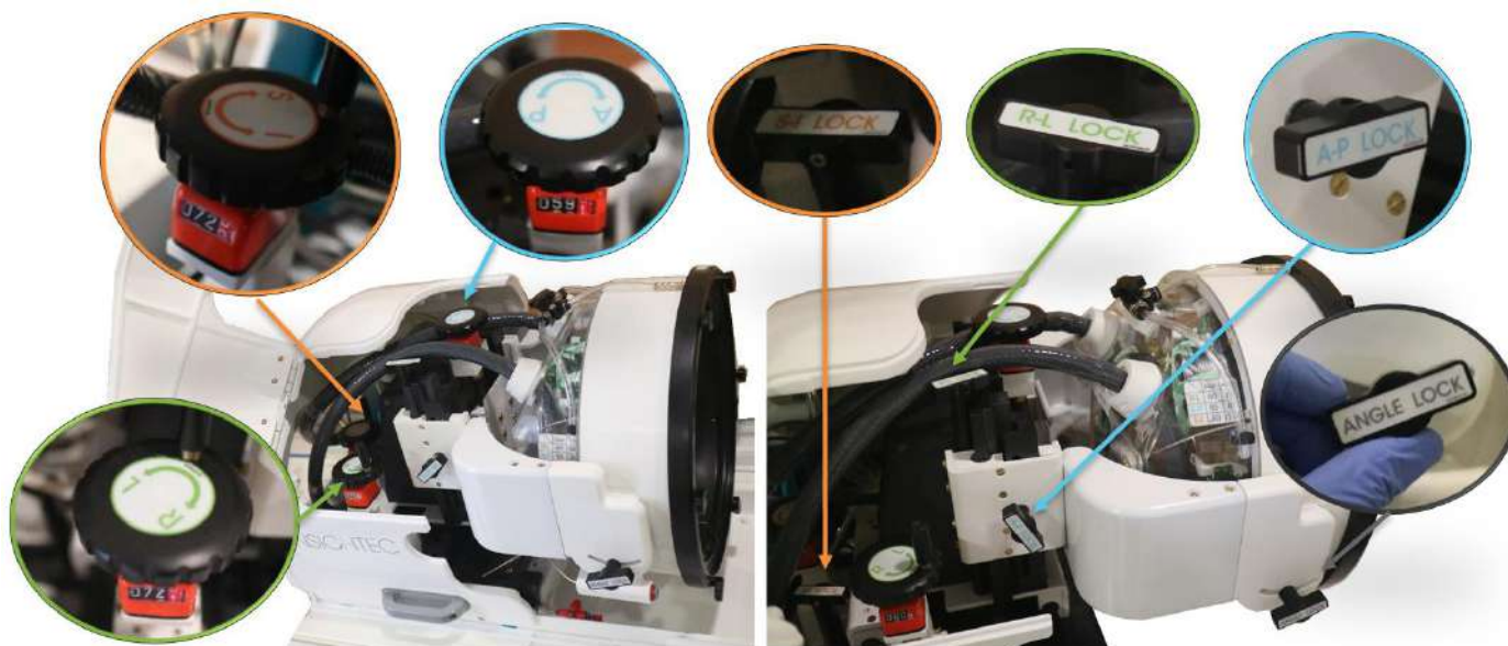
Figura 3-10. Unità di posizionamento meccanico. Leve (sinistra), blocchi (destra).
