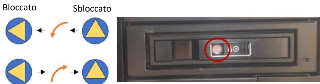
Figura C-3. Foro della chiave e posizioni di blocco/sblocco
