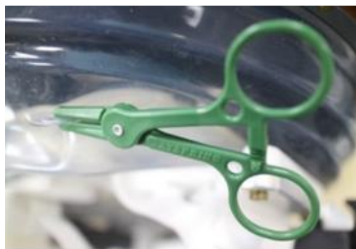
Figura 3-27. Esempio di utilizzo del morsetto di attenuazione delle perdite
