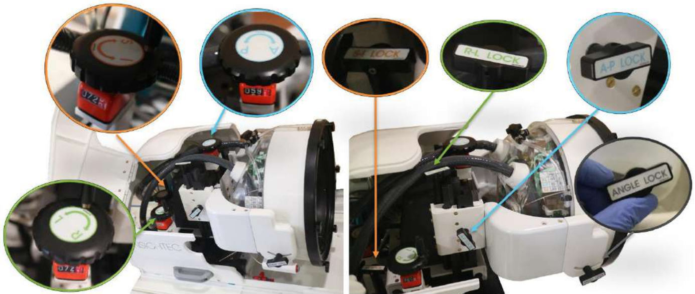
Figure 3-11 : Unité de positionnement mécanique. Leviers (gauche), dispositifs de verrouillage (droite).
