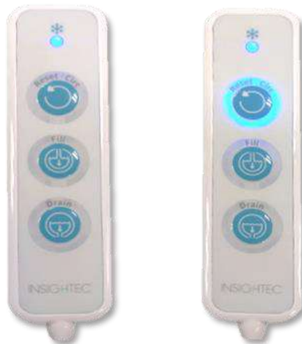
Figure 3-20 : États de la télécommande du système de distribution d'eau : veille (à gauche) et lorsque la circulation est active (à droite)
