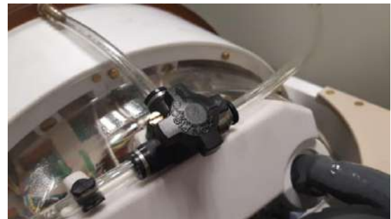
Figure A-2 : (G) Poche pour l'eau et tuyau en silicone avec raccords, (D) Ouverture de la vanne de purge d'air
