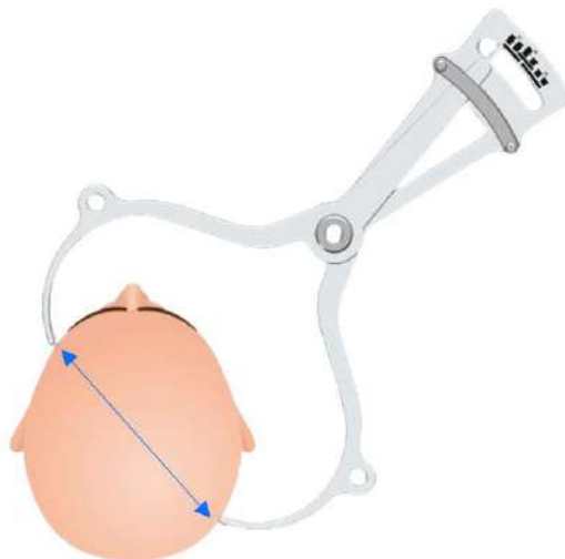
Figure 1-13 : Compas Exablate pour la mesure de la diagonale de la tête et l'estimation de la combinaison d'adaptateurs correcte
