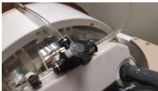
Figure B-2 : (G) Poche pour l'eau et tuyau en silicone avec raccords, (D) Ouverture de la vanne de purge d'air
