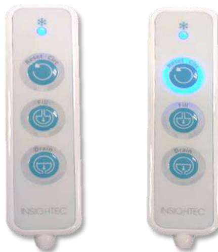
Figure 3-19 : États de la télécommande du système de distribution d'eau : veille (à gauche) et lorsque la circulation est active (à droite)
