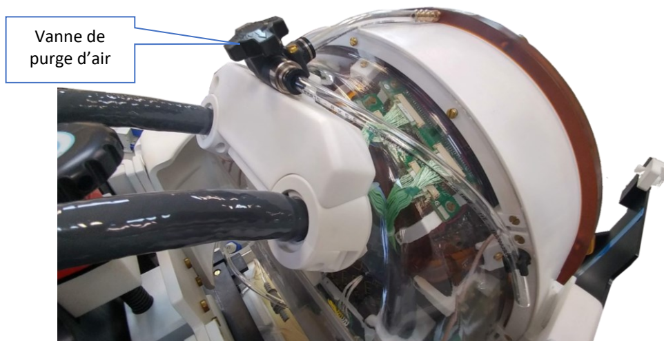
Figure 12-11: Vanne de purge d'air (ouverte)
