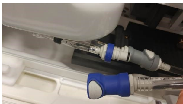
Figure 13A-1 : Débranchement des raccords pour l'eau
