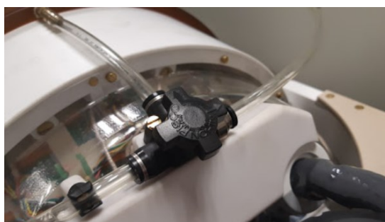
Figure A-2 : (G) Poche pour l'eau et tuyau en silicone avec raccords, (D) Ouverture de la vanne de purge d'air
