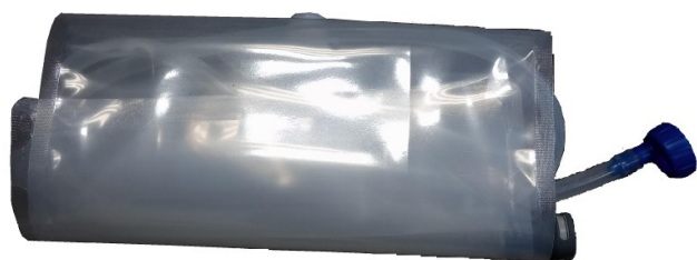
Figure A-2 : (G) Poche pour l'eau et tuyau en silicone avec raccords, (D) Ouverture de la vanne de purge d'air
