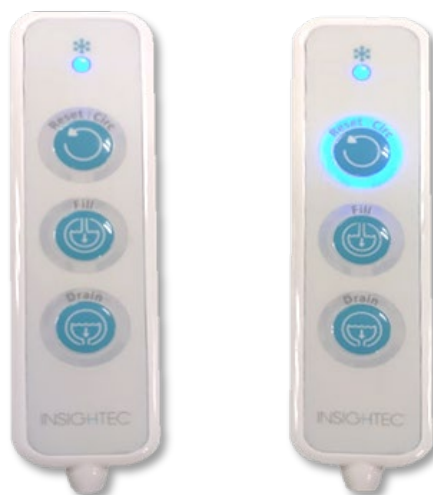
Figura 3-20: Estados del controlador remoto del circuito de agua: Inactivo (izquierda) y mientras la circulación está activada (derecha)
