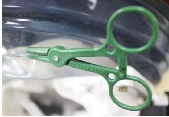
Şekil 3-22: Sızıntı Azaltma Kelepçesi kullanım örneği
