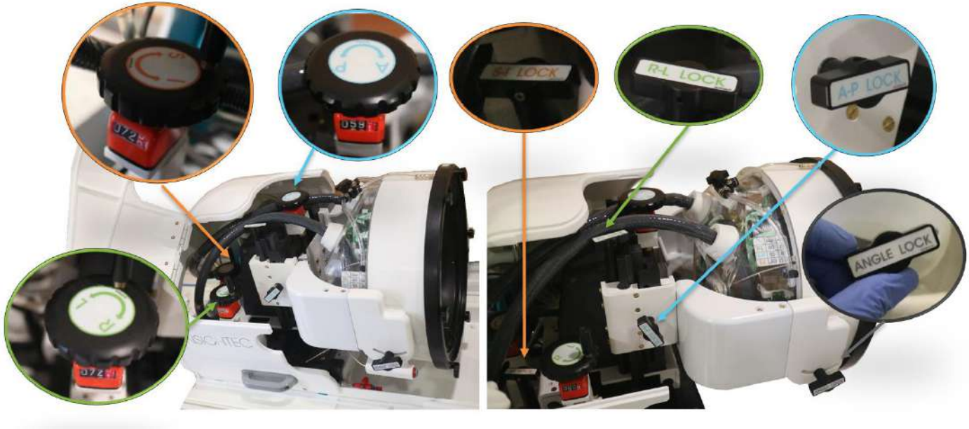
Şekil 3-12 Tip 1.1 Mekanik Konumlandırma Ünitesi, Kollar (Sol), Kilitler (Sağ)
