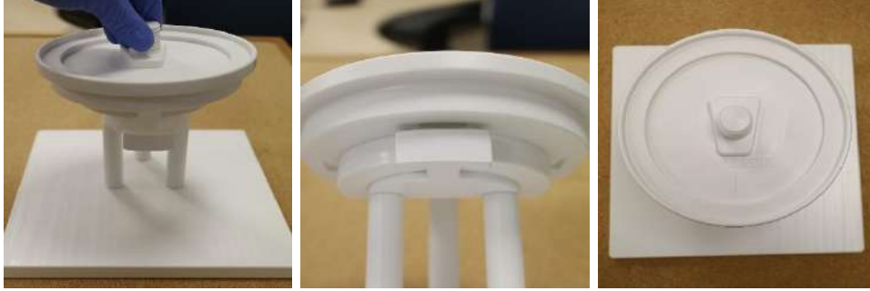
Şekil 5-3: DQA Tutucu ve Montaj Aparatı Tertibatı
