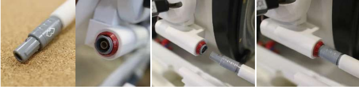
Şekil 1-32: Sargı Konektör Soketine bağlanan Sargı Konektör Fişi (yalnızca gösterim amaçlıdır).
