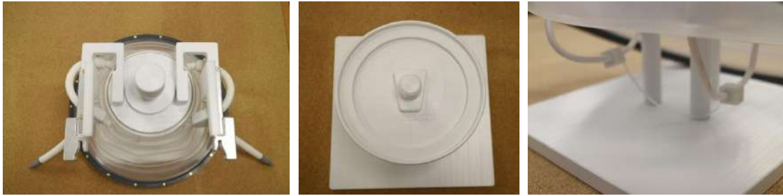
Şekil 5-4: Membran, Üst ve Alt Kafa Sargılarının yerleşimi.
