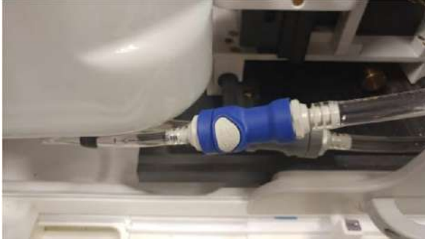
Şekil C - 1: Su armatürü bağlantısının kesilmesi
