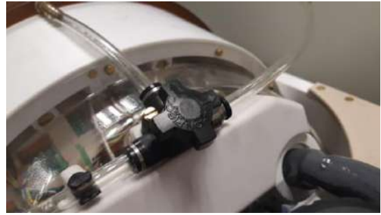
Şekil C - 2: (L) Su kesesi ve bağlantı parçalı Silikon tüp, (R) Hava tahliye Vanası açıklığı
