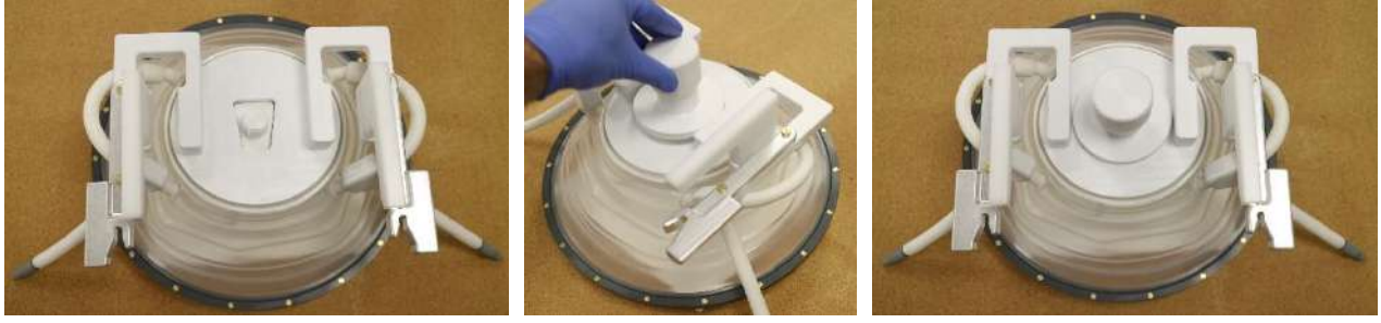
Şekil 5-5: DQA Düzenek Tutucu Montajı
