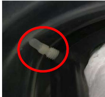
Şekil 1-22 Vidanın ucundaki membran koruyucu silikon kapaklar
