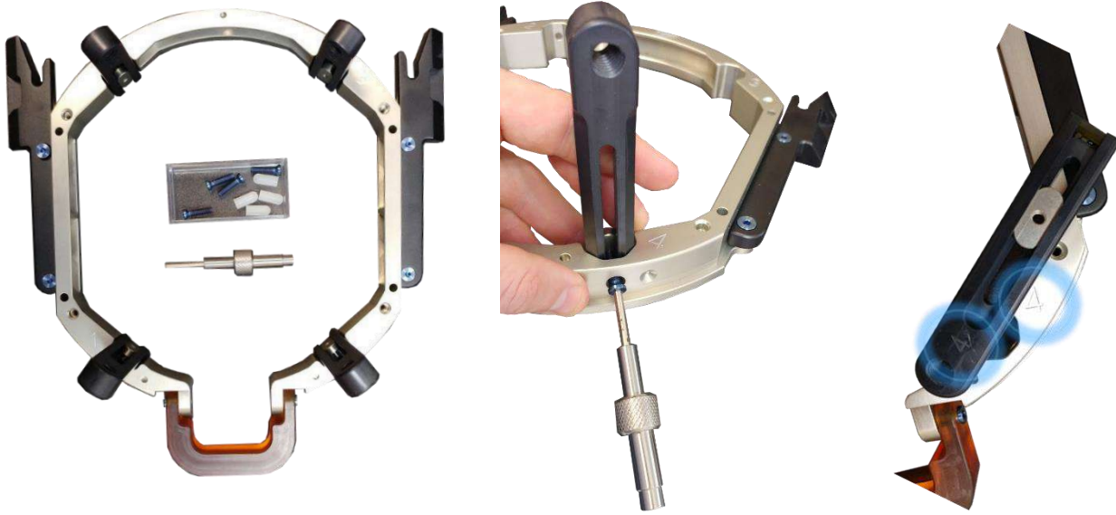
Şekil A - 3: Çerçeve Direklerinin bağlanması (yalnızca gösterim amacıyla)
