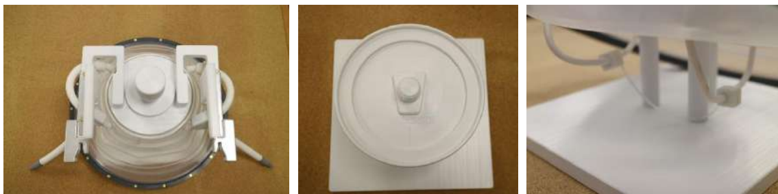
Figur 5-4: Membran, överordnade och underordnade huvudspolars placering.
