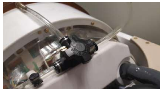
Figur C - 2: (L) Vattenpåse och silikonslang med kopplingar, (R) Luftutlösningssventilöppning
