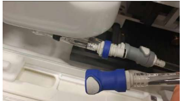
Figur C - 1: Frånkoppling av vattenarmatur
