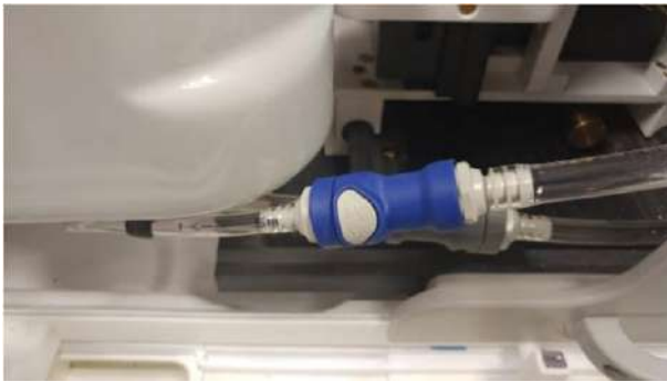
Figur C - 1: Frånkoppling av vattenarmatur
