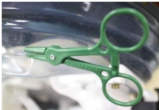
Figur 3-22: Exempel på Läckagereducerande klämmas användning
