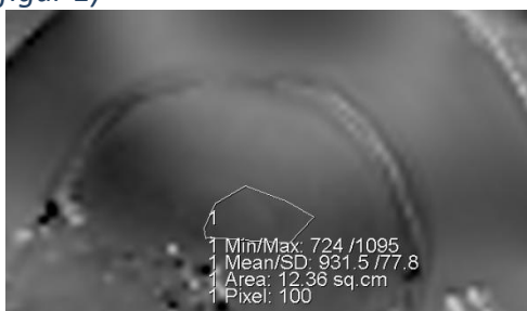
Fig. 3: ROI-ritning runt mitten av DQA Fantom
