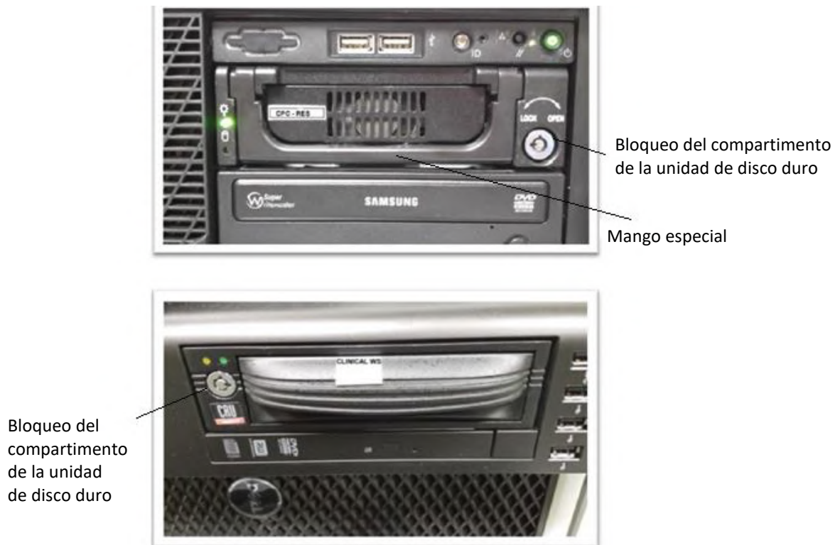
Figura D-2: Compartimento del disco duro de los PC (observe la ranura con las designaciones de las posiciones Open/Lock [Abrir/Cerrar])
