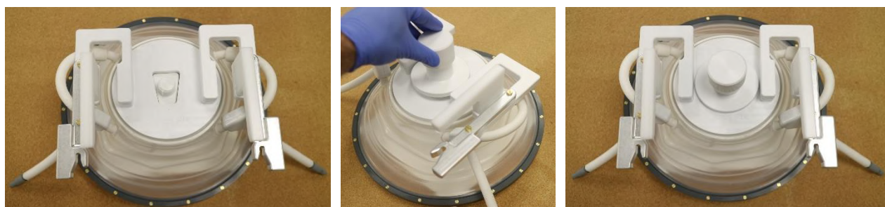
Figura 5-5: montaje del soporte de montaje del DQA
