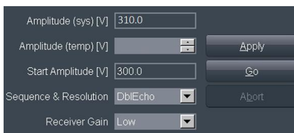
Fig. 2: actualización del valor de amplitud (ejemplo, SIEMENS VE11e\VE11c)
