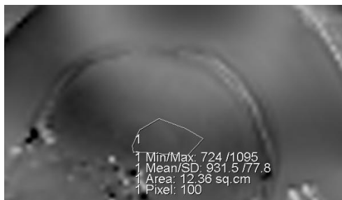
Fig. 2: dibujo de una ROI alrededor del centro del simulador del DQA
