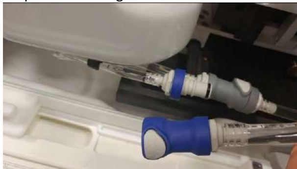
Figura C – 1: Desligar o encaixe de água
