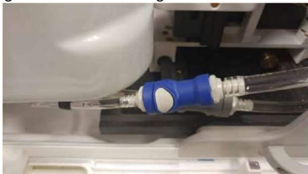
Figura C – 1: Desligar o encaixe de água
