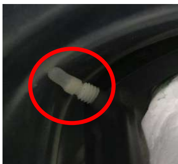
Figura 1-22 Tampas de silicone protetoras da membrana na extremidade do parafuso
