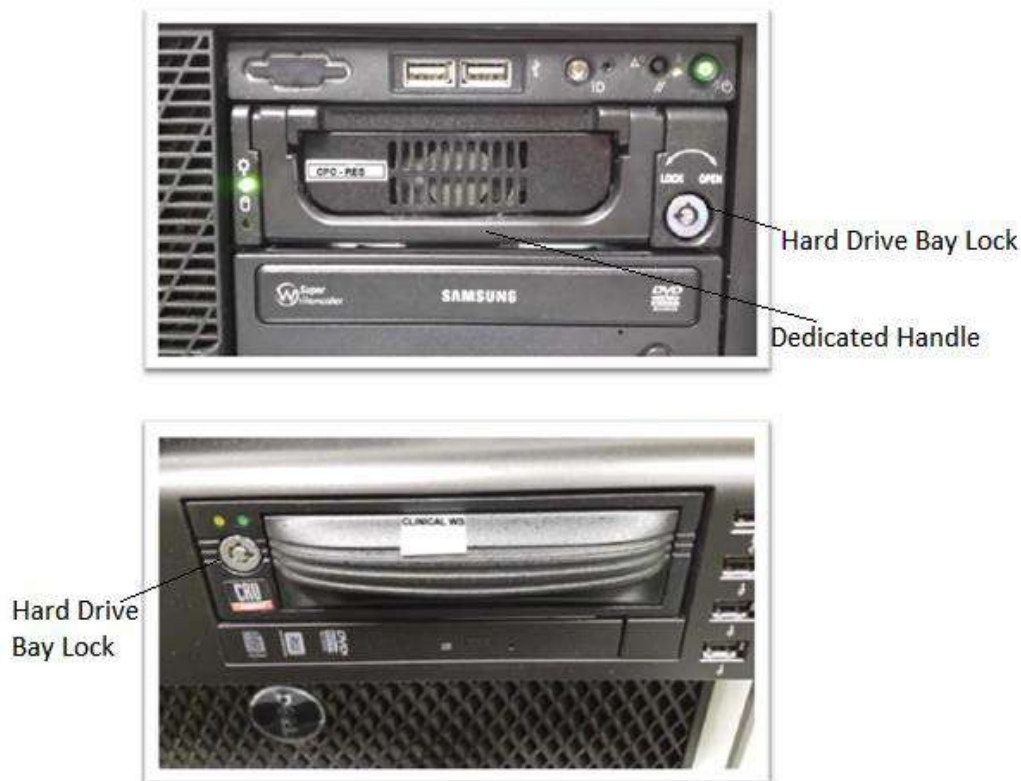
Figura D – 2: Compartimento de disco rígido dos PCs (Atente nas marcações de posição Aberto/Fechado da ranhura de chaves)
