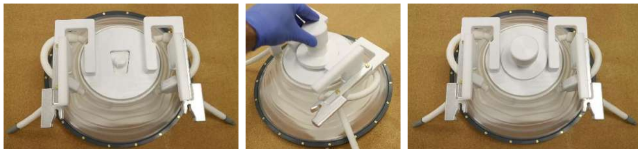
Figura 5-5: Montagem do suporte de configuração DQA
