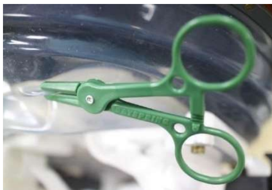
Figura 3-22: Exemplo de utilização de clampe de mitigação de fugas
