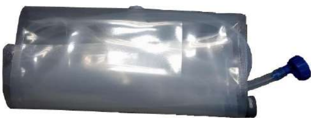
Figura C – 2: (E) Bolsa de água e tubo de silicone com guarnições, (D) Abertura da válvula de descarga de ar
