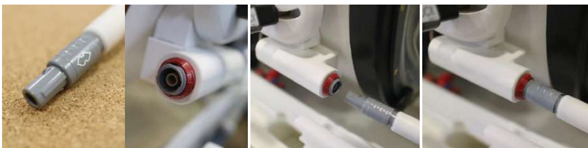
Figura 1-32: Ficha do conector da antena ligada à tomada de ligação (apenas para efeitos ilustrativos).
