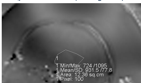
Fig. 3: Desenho ROI no centro do Phantom DQA
