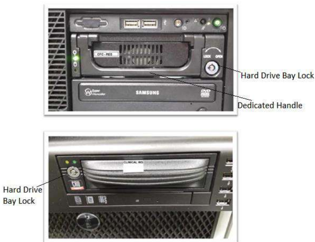
Rysunek D - 2: Wnęka dysku twardego PC (Uwaga: otwór na klucz z oznaczeniami pozycji otwarcia/zablokowania)
