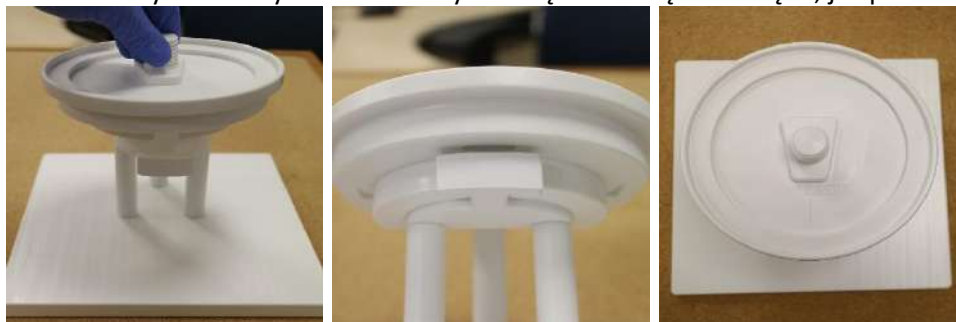
Rysunek 5-3: Instalacja uchwytu DQA i elementu montażowego
