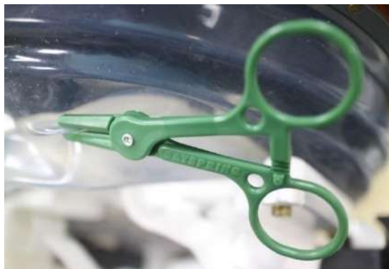
Rysunek 3-22: Przykład zastosowania zacisku ograniczającego przeciek
