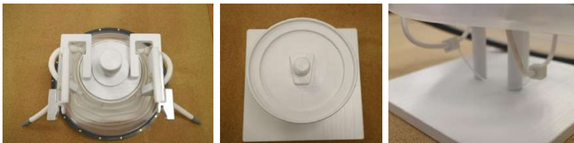
Rysunek 5-4: Membrana, górne i dolne położenie cewki głowowej.
