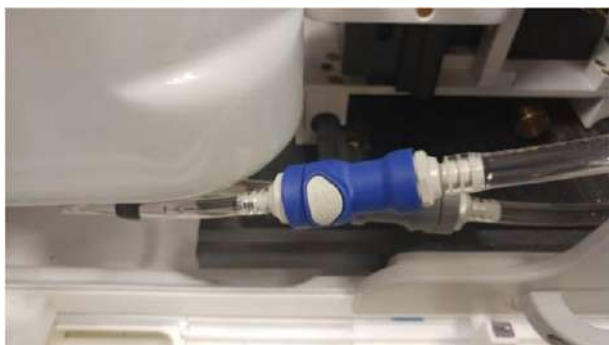
Rysunek C - 1: Odłączenie przyłącza wody
