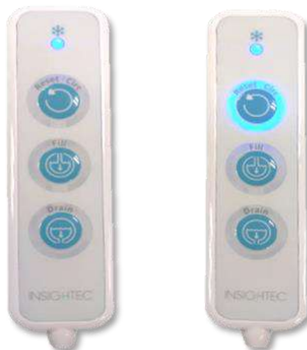
Rysunek 3-17: Stany pilota zdalnego sterowania układu wodnego typu 1.1 Obroty biegu jałowego (lewa strona) i gdy cyrkulacja jest aktywna (prawa strona)
