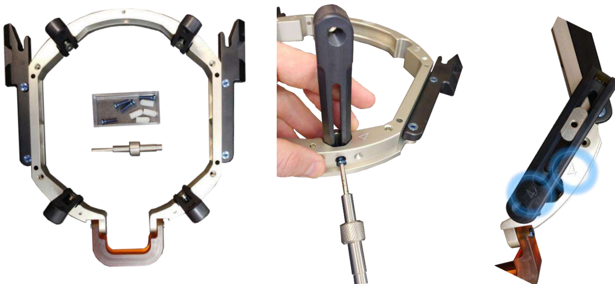
Figura B - 8. Collegamento dei perni del telaio (solo a scopo illustrativo)
