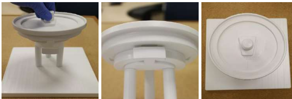
Figura 5-3. Montaggio del supporto DQA sulla dima di montaggio
