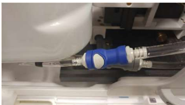
Figura C - 1. Scollegamento del raccordo dell'acqua
