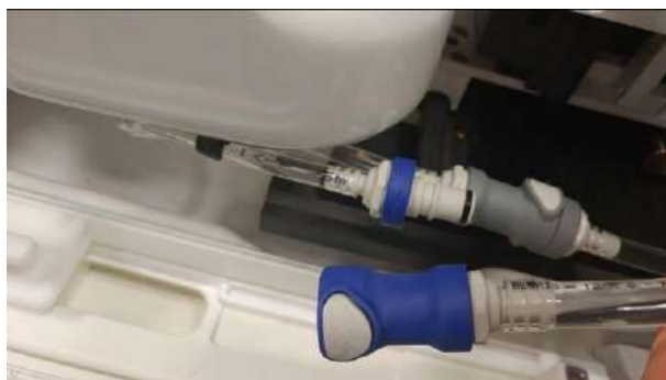
Figura C - 1. Scollegamento del raccordo dell'acqua
