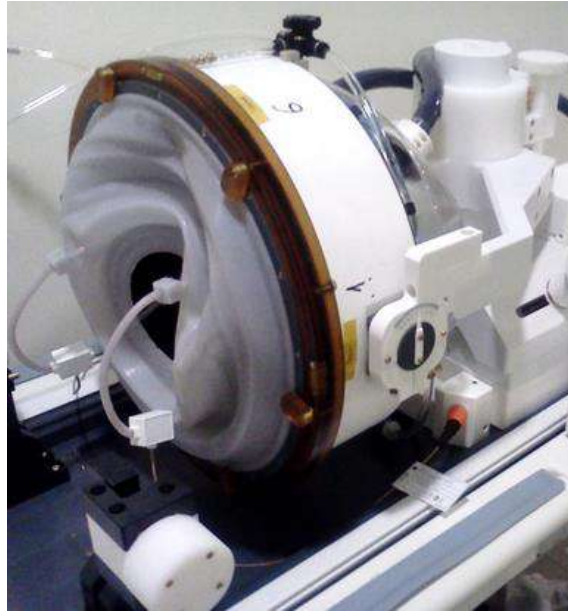
Figura 3-15. Spina e presa del connettore della bobina per testa TcMRgFUS da 1,5 T (tipo 1.0) (solo a scopo illustrativo).
