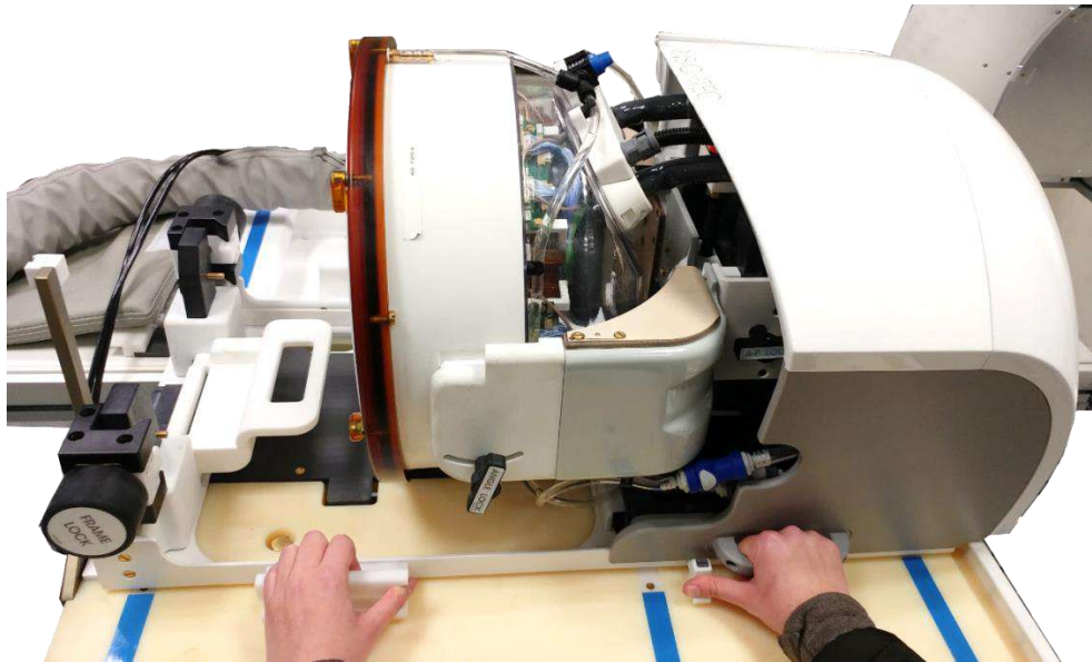
Figura 3-6. Trasferimento del sistema a casco sul tavolo RM
