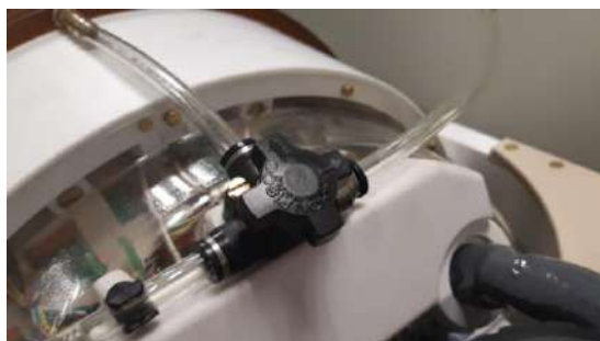
Figura C - 2. (sx) Sacca dell'acqua e tubo in silicone con raccordi, (dx) apertura della valvola di rilascio dell'aria
