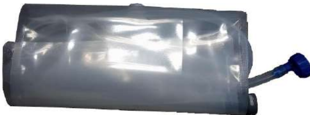
C-2. Ábra2: (Bal) Vízszak és szilikoncső szerelvényekkel, (Jobb) Levegőkioldó szelep nyílása
