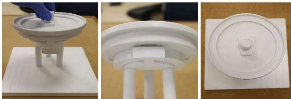
5-3. Ábra53: DQA tartó és a szerelő eszköz összeszerelése
