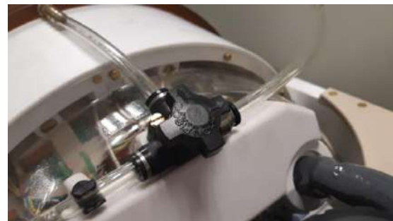
C-2. Ábra2: (Bal) Vízszak és szilikoncső szerelvényekkel, (Jobb) Levegőkioldó szelep nyílása
