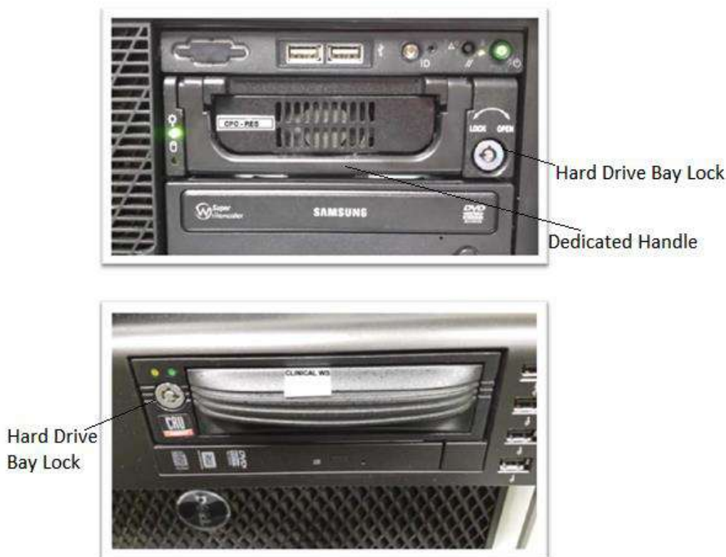
D - 2. Ábra2: PC merevlemez meghajtó rekesz (Figyelje meg a kulcslyukat a nyitott/zárt pozíció megjelöléssel)
