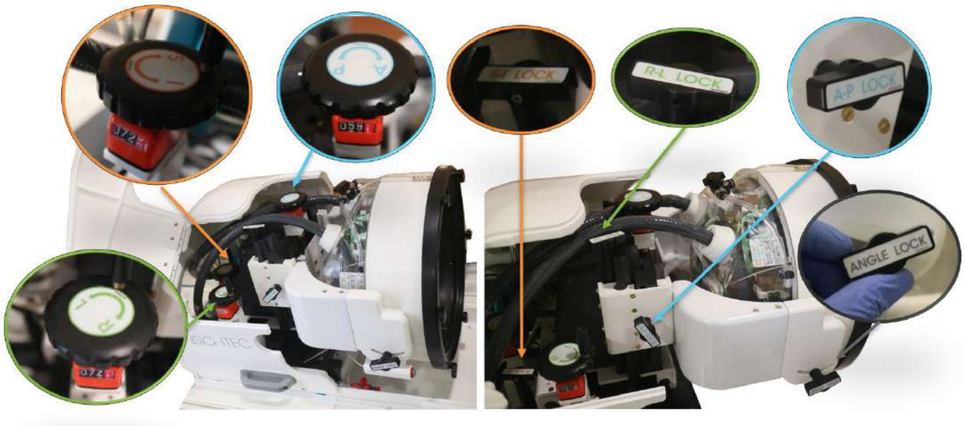
3-12. Ábra312: 1.1 típusú mechanikai pozicionáló egység, karok (bal), zárok (jobb)
