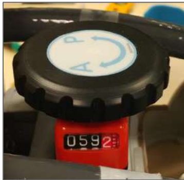
Εικόνα 3-14: Μοχλός ρυθμιστή θέσης A-P για Τύπο 1.1
