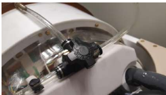
Εικόνα Γ - 2: (Αρ) Ασκός νερού και σωλήνας σιλικόνης με εξαρτήματα, (Δε) άνοιγμα βαλβίδας απελευθέρωσης αέρα
