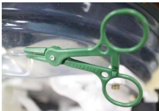
Εικόνα 3-22: Παράδειγμα χρήσης σφιγκτήρα μετριάσμού διαρροών
