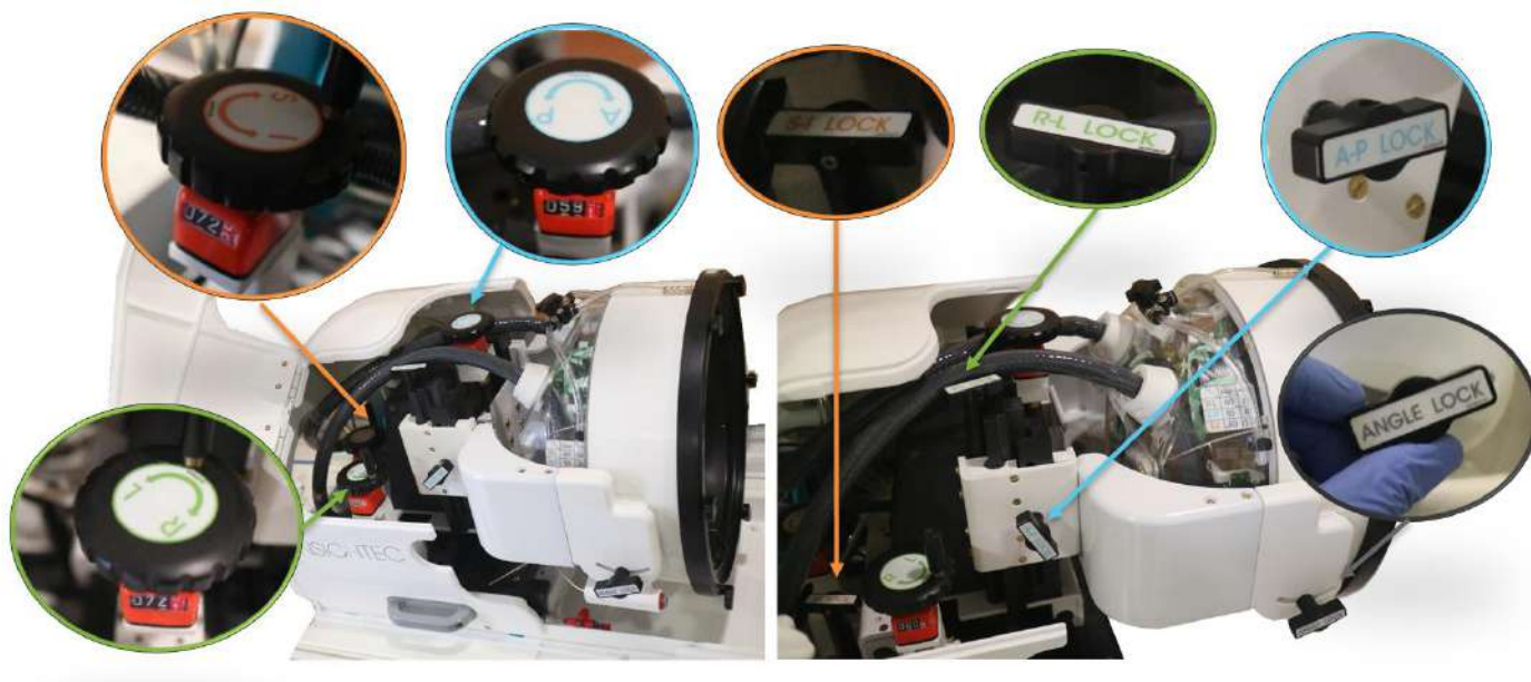
Εικόνα 3-12 Μονάδα μηχανικής τοποθέτησης, μοχλοί (Αριστερά), ασφάλειες (Δεξιά) τύπου 1.1
