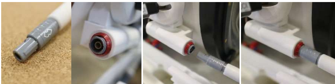
Εικόνα 1-32: Βύσμα συνδέσμου πηνίου που συνδέεται στην υποδοχή συνδέσμου πηνίου (μόνο για λόγους ενδεικτικής παρουσίασης).
