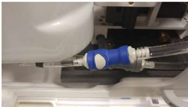
Εικόνα Γ - 1: Αποσύνδεση εξαρτήματος νερού
