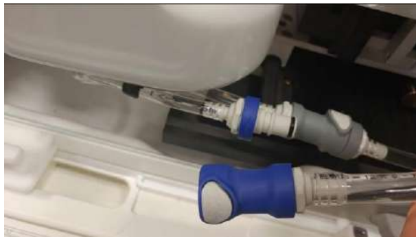
Εικόνα Γ - 1: Αποσύνδεση εξαρτήματος νερού
