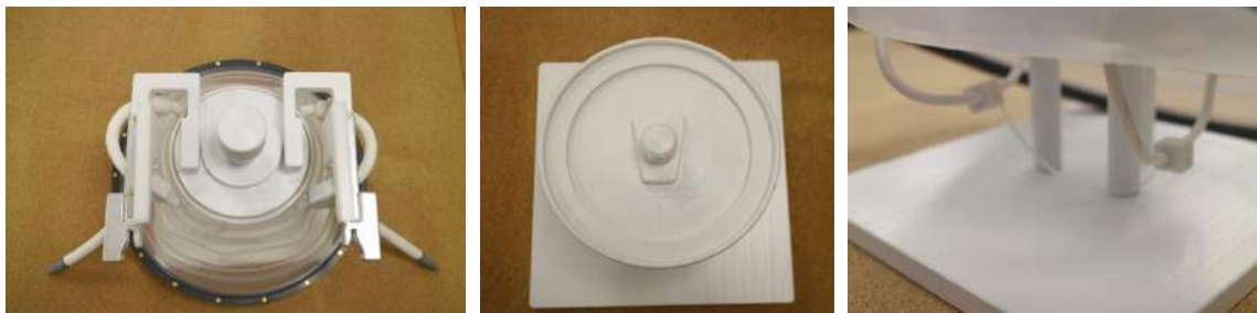
Εικόνα 5-4: Διάταξη μεμβράνης, άνω και κάτω πηνίου κεφαλής.
