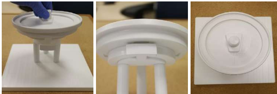
Εικόνα 5-3: Διάταξη βάσης DQA και πλάκας υποστήριξης
