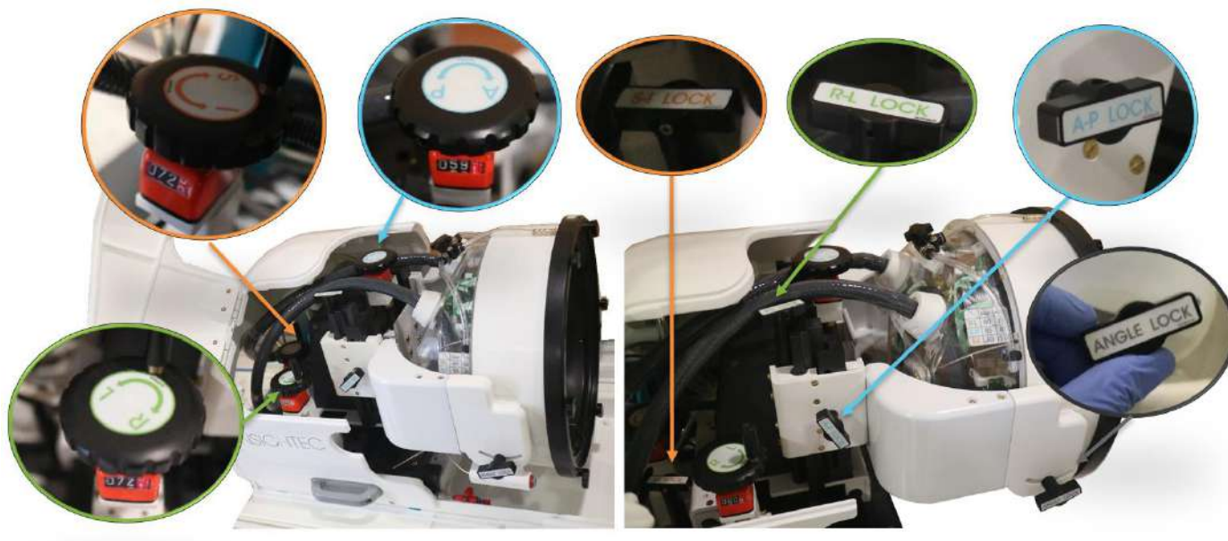
Figure 3-12 Unité de positionnement mécanique pour Type 1.1, leviers (G), verrous (D)
