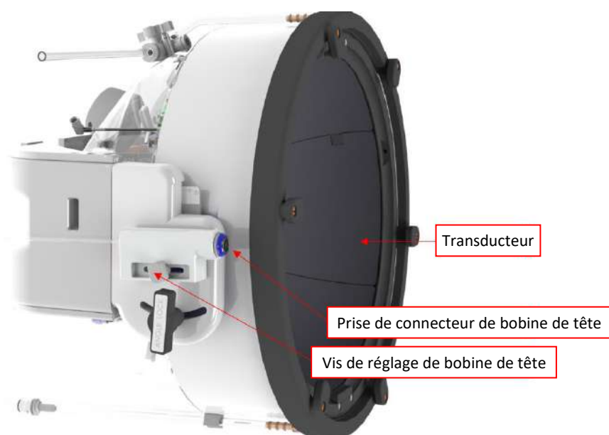
Figure 1-31 : Prise de connecteur de bobine de tête (pour tous les types de bobines, à l'exception du type GE 1,5 T [1.0]).
