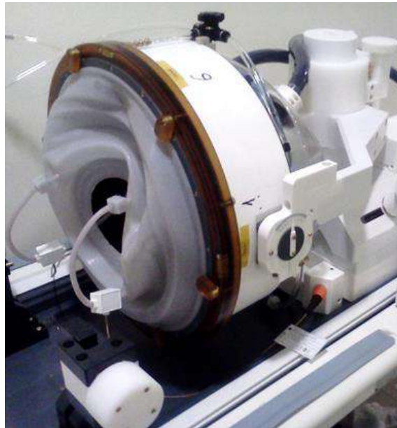
Figure 3-15 : Fiche et prise du connecteur de la bobine de tête Tc MRgFUS de 1,5 T (Type 1.0) (à des fins d'illustration uniquement)
