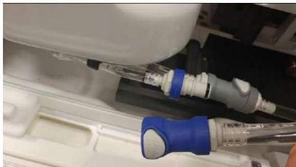
Figure C - 1 : Débranchement des raccords pour l'eau
