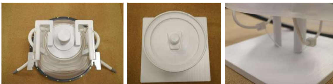
Figure 5-4 : Disposition de la membrane et des bobines de tête supérieure et inférieure.
