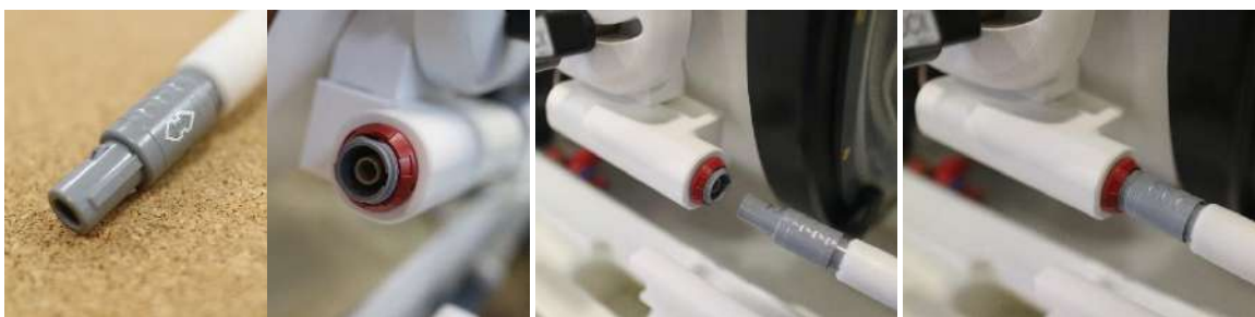
Figure 1-32 : Connexion de la fiche du connecteur de la bobine à la prise de connecteur de la bobine (à des fins d'illustration uniquement).
