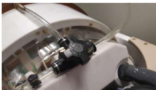
Figure C - 2 : (G) Poche pour l'eau et tuyau en silicone avec raccords, (D) Ouverture de la vanne de purge d'air
