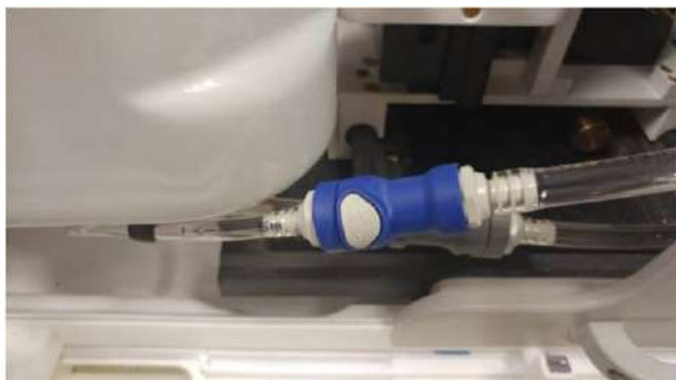
Figure C - 1 : Débranchement des raccords pour l'eau
