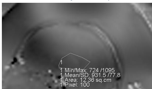
Fig. 1 : Dessin d'une ROI autour du centre du fantôme pour la DQA
