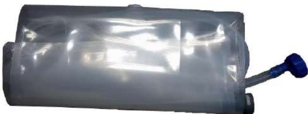
Kuva C - 2: (Vasen) vesipussi ja silikoniletku liitäntäosilla, (oikea) ilmanpoistoventtiili
