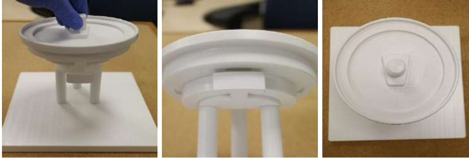
Kuva 5-3: DQA-pidikkeen ja asennusalustan kokoaminen
