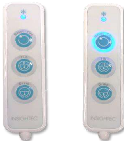
Kuva 3-17: Tyypin 1.1 vesijärjestelmän kauko-ohjaimen tilat Joutilaana (vasen) ja kierron ollessa aktiivinen (oikea)
