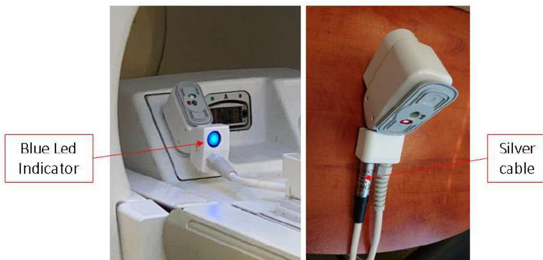
Kuva 1-33: Esimerkkejä MK-liittimistä
