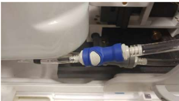
Kuva C - 1: Vesiliitännän irrottaminen
