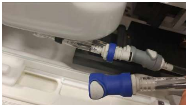
Kuva C - 1: Vesiliitännän irrottaminen
