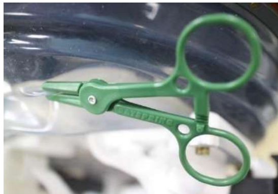
Kuva 3-22: Esimerkki vuotopuristimen käytöstä
