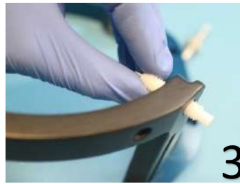
Kuva 1-19: Ruuvien paikalleen työntäminen päätuken sisäpuolelta
