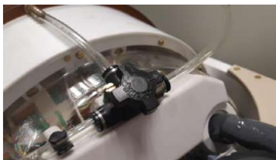
Kuva C - 2: (Vasen) vesipussi ja silikoniletku liitäntäosilla, (oikea) ilmanpoistoventtiili
