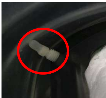
Kuva 1-22: Kalvoa suojaava silikonitulppa ruuvien päissä
