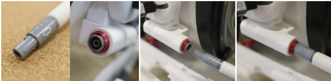
Kuva 1-32: Kelan liitinpistokkeen liittäminen kelan liitinpistorasiaan (havainnollistava kuva).
