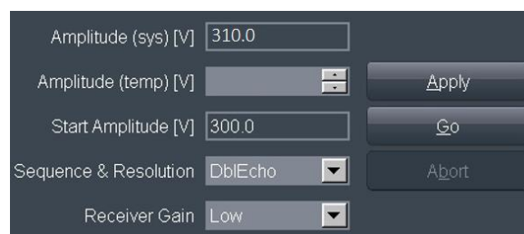
kuva 2: Amplitudiarvon päivittäminen (esim. SIEMENS VE11e\VE11c).
