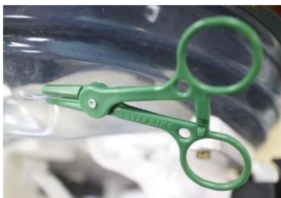
Figur 3-22: Eksempel på brug af klemme til lækagebegrænsning
