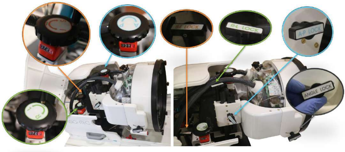
Figur 3-12: Type 1.1 Mekanisk positioneringsenhed, håndtag (L), låse (R)
