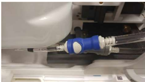
Figur C - 1: Afbrydelse af vandinstallation
