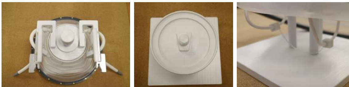
Figur 5-4: Membran, øvre og nedre hovedspole-disposition.
