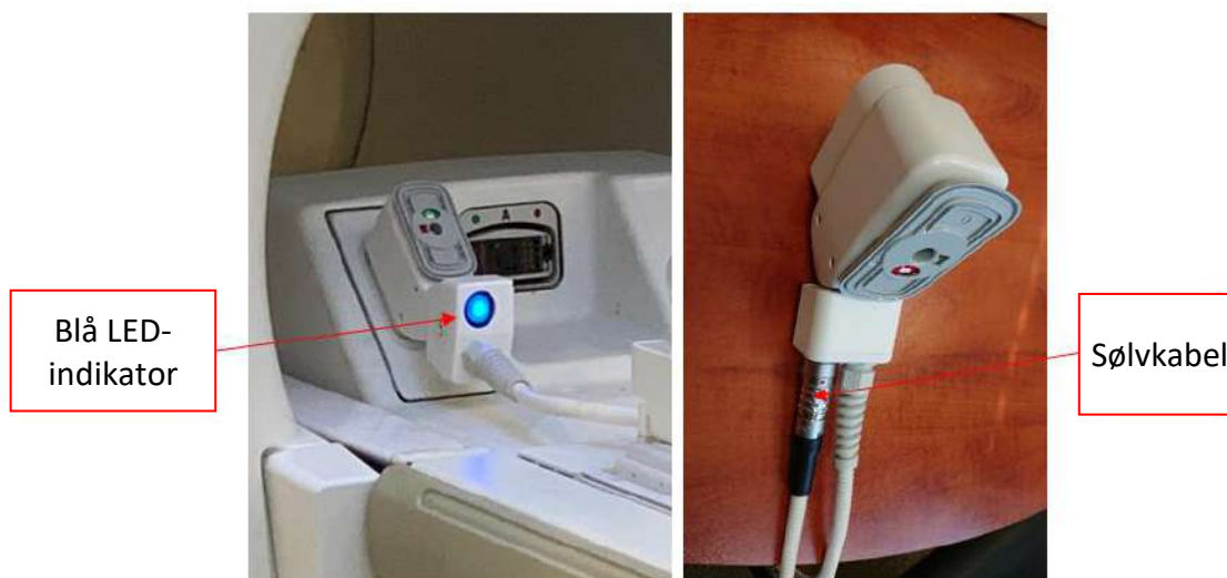
Figur 1-33: Eksempler på MR-stik
