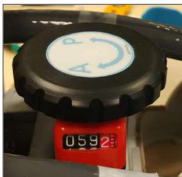
Figur 3-14: Type 1.1 A-P-positioneringshåndtag
