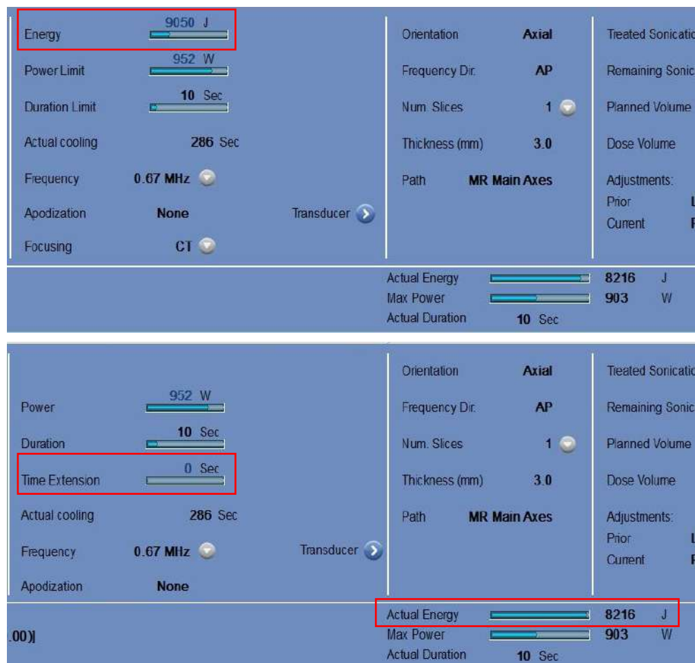
Figur 10-2: WS7.0 Behandlingsens soniceringsparametre vises på WS 7.0 (øverst) sammenlignet med WS 7.33 (nederst)
