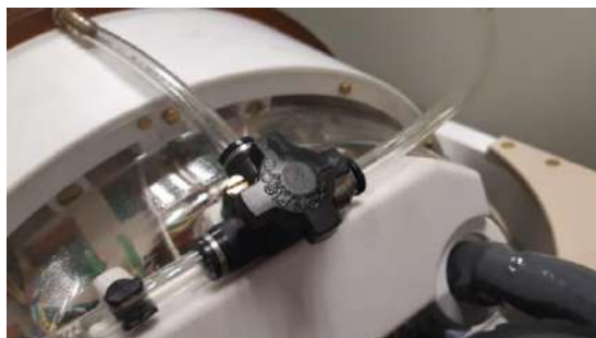
Figur C — 2: (L) Vandpose og silikoneslange med armaturer, (R) Åbning for luftudløbsventil
