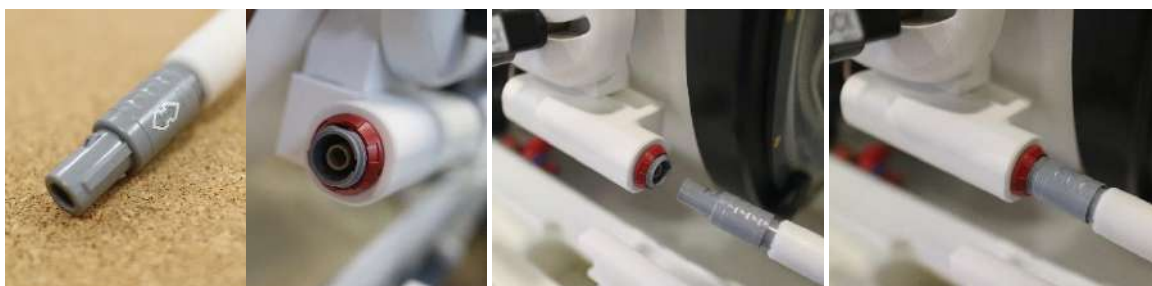
Figur 1-32: Spolekontaktens stik, der tilsluttes til spolekontaktens stikkontakt (kun til illustration)
