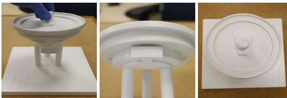
Figur 5-3: DQA-holder og monteringsanordning
