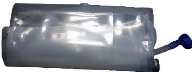
Abbildung C – 2: (L) Wasserbeutel und Silikonschlauch mit Anschlussstücken, (R) Öffnen des Entlüftungsventils
