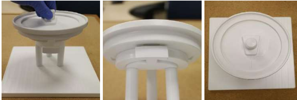
Abbildung 5-3: Zusammenbau von DQA-Halter und Montagevorrichtung
