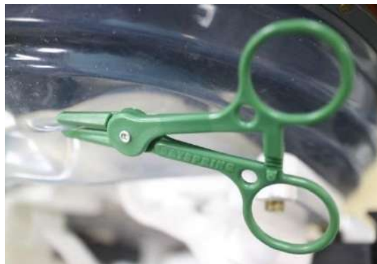
Abbildung 3-22: Beispiel für die Verwendung einer Leckabdichtungsklemme
