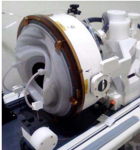
Abbildung 3-15: 1,5 T (Typ 1.0) TcMRgFUS-Kopfspulen-Anschlusstecker und -buchse (nur zur Veranschaulichung).
