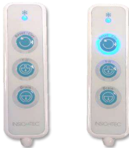
Abbildung 3-17: Typ 1.1 – Statusanzeige der Fernbedienung für das Wassersystem bei Leerlauf (links) und bei aktiver Zirkulation (rechts)
