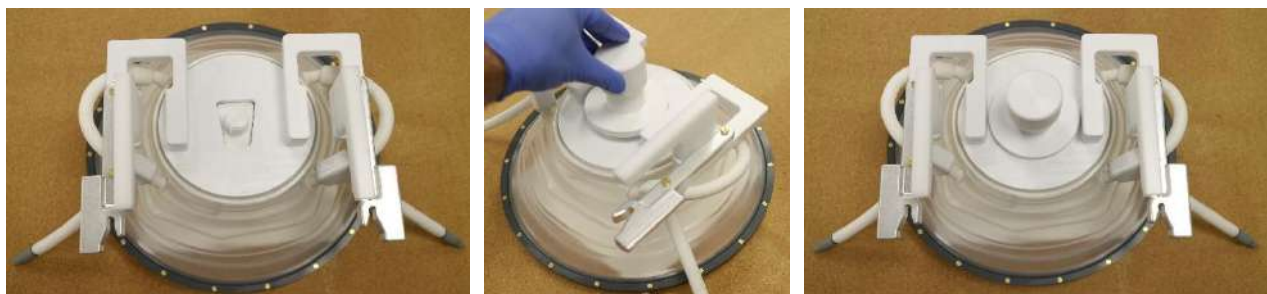
Abbildung 5-5: Zusammenbau des DQA-Einrichtungshalters
