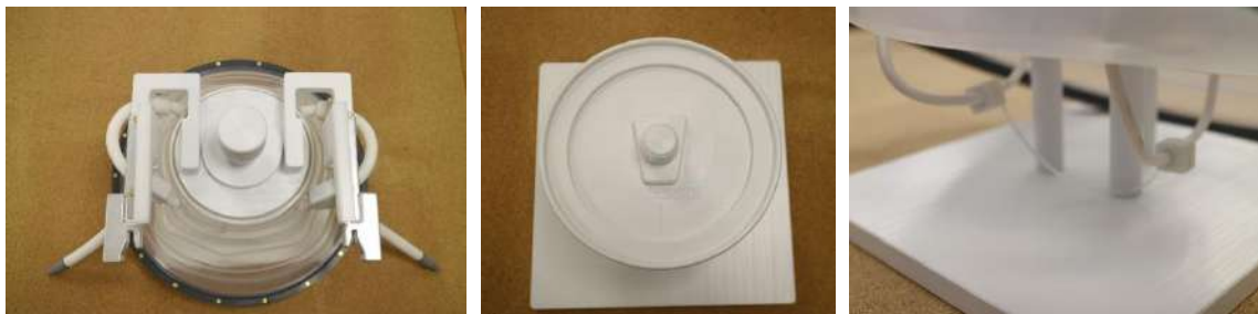
Abbildung 5-4: Membran, Anordnung der oberen und unteren Kopfspulen.
