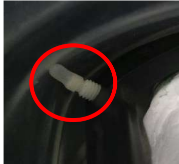
Abbildung 1-22: Membranschutzkappen aus Silikon an den Enden der Schraube
