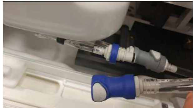
Abbildung C – 1: Lösen des Wasser-Anschlussstücks
